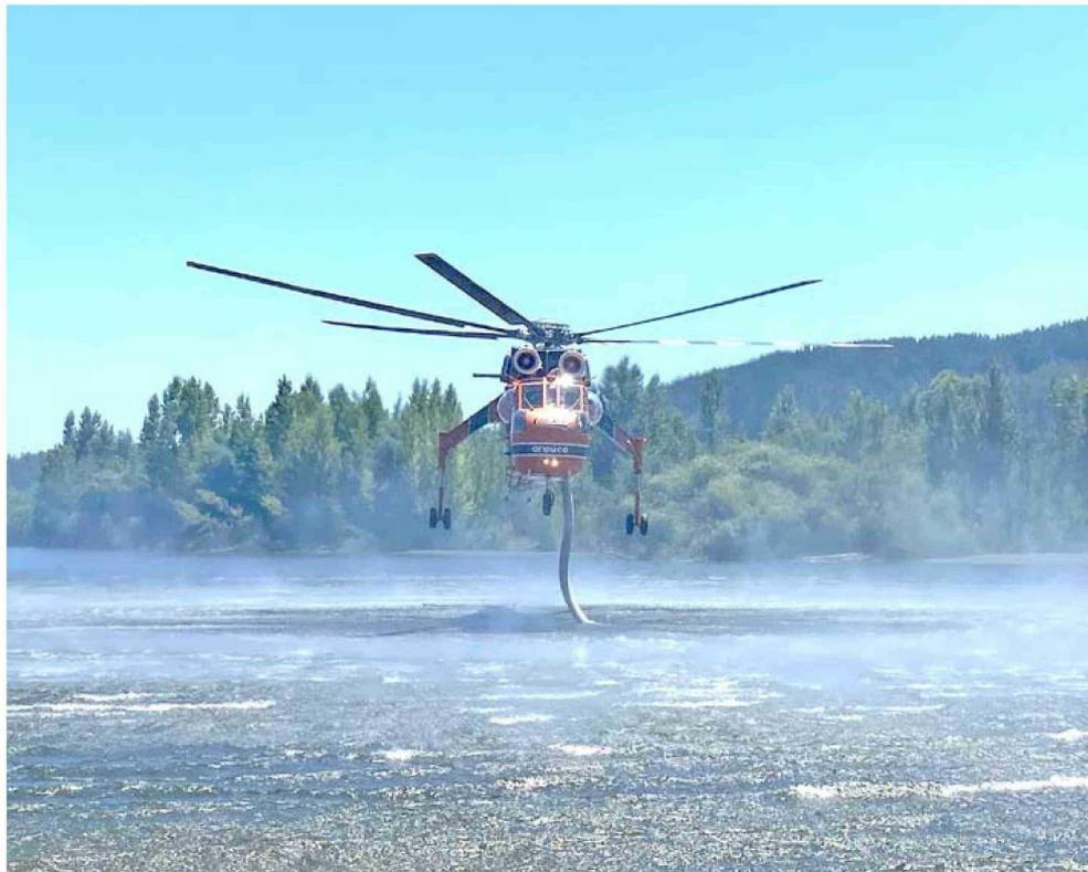
Permiten efectuar hasta 10 descargas por hora, con una recarga que solo demora 45 segundos.
