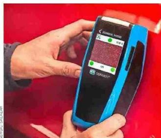
Mediante el uso de un espectro fotómetro se captura una imagen para iniciar el proceso de elaboración de color.
