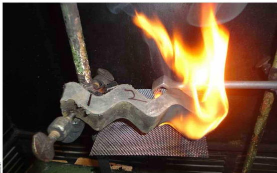
IDIEM cuenta con un laboratorio de ensayo de resistencia al fuego de soluciones constructivas.
