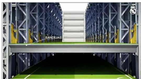
Las placas de pasto se guardan en compartimientos subterráneos que tiene la cancha.
