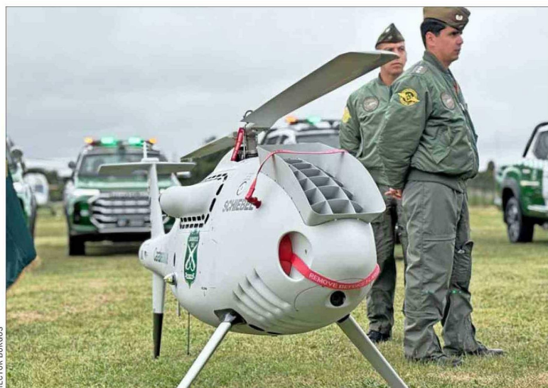
Las aeronaves Camcopter S-100 tienen un alcance de 200 kilómetros y pueden transmitir imágenes en tiempo real.
