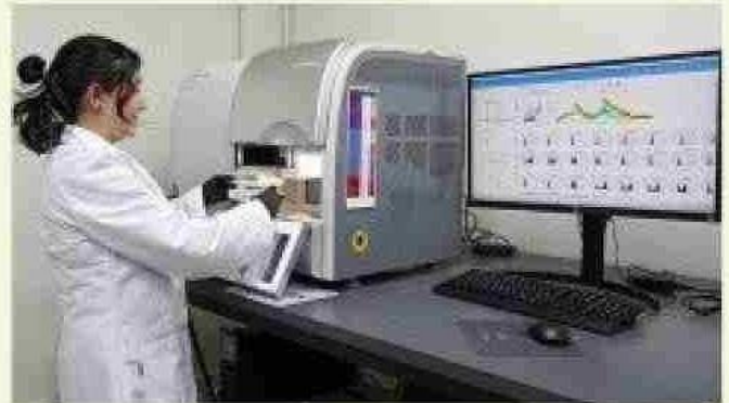
La Dra. María Inés Barría introduciendo una muestra al equipo Cytex Aurora que detecta, separa y clasifica miles de células en cosa de segundos.
