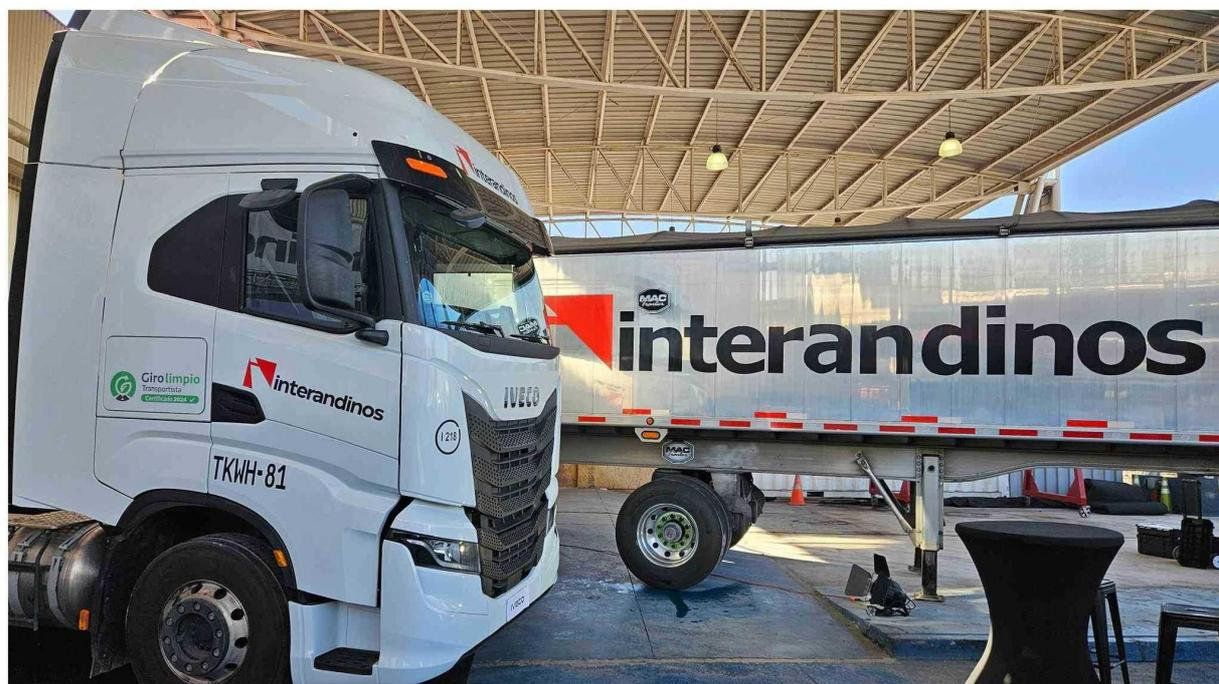
tores diésel, dado que la propulsión GNL es más eficiente y menos contaminante. Finalmente, los intervalos de mantenimiento se extienden a los 90 mil kilómetros, es decir 30 mil kilómetros más que un camión similar impulsado por diésel.
