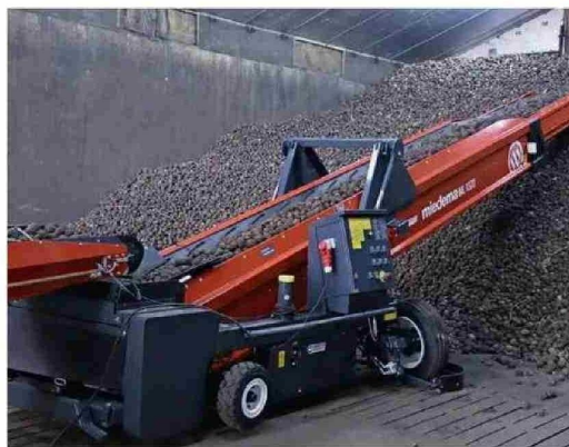
Cargador de almacén Miedema ML 1370 Farmer ofrece una capacidad notable de 130 a 180 toneladas por hora. Su cinta de PVC de 70 cm de ancho, con diseño en forma de V profunda, asegura un manejo suave de los cultivos durante la carga en el almacén.
