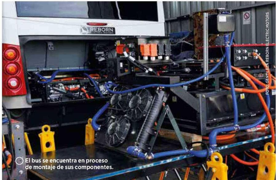
El bus se encuentra en proceso de montaje de sus componentes.
