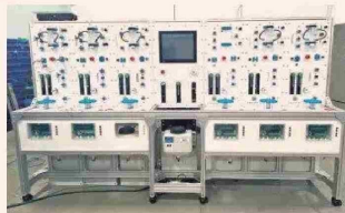
Equipo propio de Summit para probar la robustez del adsorbente.
