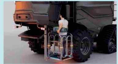
Elevador de acceso a maquinaria Elevatorbot. Foto: F. Contreras, C. Farri/Promoingenio.
