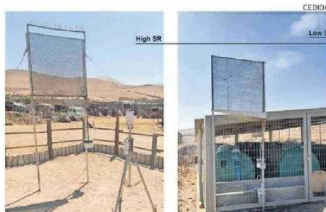
COLECTORES DE NIEBLA ESTÁNDAR CON SR ALTO (IZQ) Y SR BAJO (DER).
