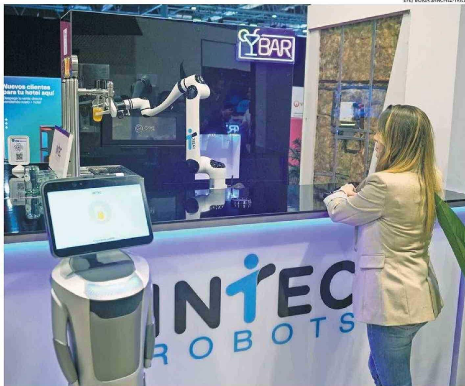
ALGUNOS RECINTOS YA USAN UN BRAZO ROBÓTICO QUE LEE LAS PULSERAS Y SIRVE LOS TRAGOS A LOS HUÉSPEDES.
