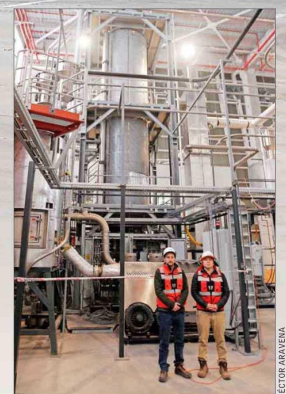
Este es el reactor que permite que el plástico pueda volver a ser usado en botellas para consumo humano
