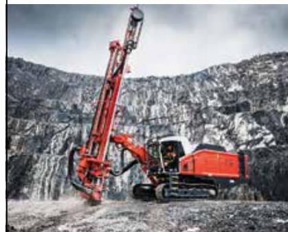
El Leopard™ DI650i es un equipo inteligente de perforación autocontenido, montado sobre oruga, con martillo de fondo y motor diésel, creado para aplicaciones de perforación de producción exigentes y de alta capacidad en minería de superficie, además de aplicaciones a gran escala en canteras.
