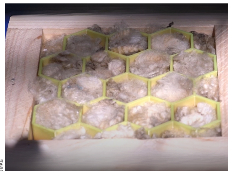
Este panel “honeycomb” está relleno con lana de oveja, enmarcado en madera, y sirve como alternativa para construcción de viviendas.
