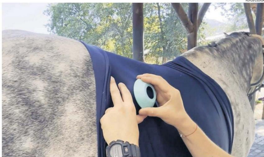
EL CHALECO POSEE UN DISPOSITIVO SIMILAR A UN FONENDOSCOPIO QUE CAPTURA EL SONIDO DEL SISTEMA DIGESTIVO DEL ANIMAL.
