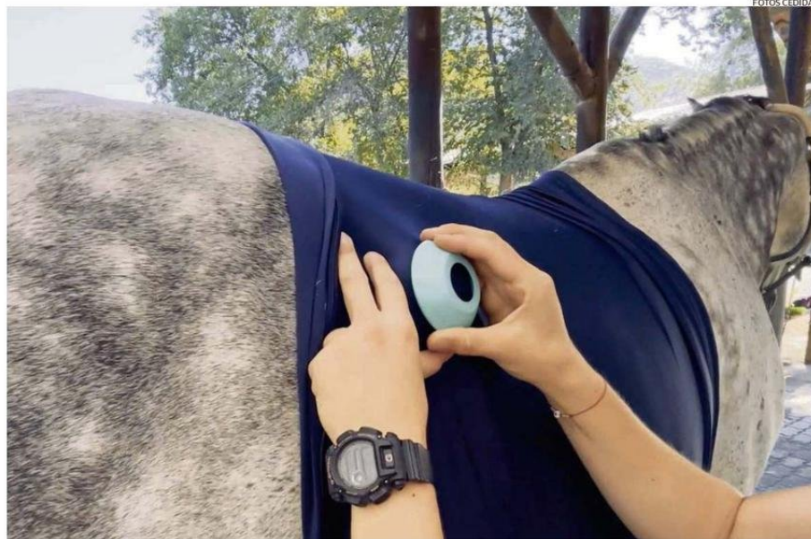
El chaleco posee un dispositivo similar a un fonendoscopio que captura el sonido del sistema digestivo del animal.
