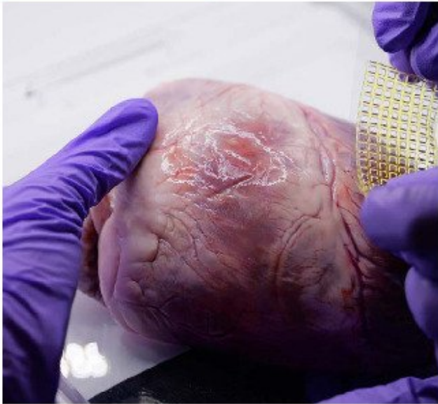
El laboratorio de Jason Burdick produce biomateriales impresos en 3D que podrían colocarse sobre un corazón humano latiendo. En la imagen, un corazón de cerdo. Foto Casey A. Cass/University of Colorado.
