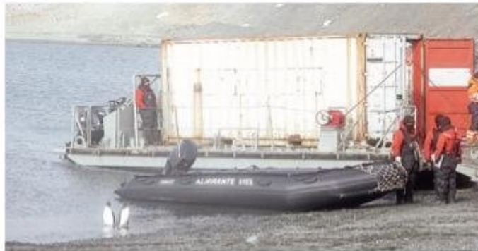
El bajo calado de la skúa permite su operación en zonas sin muelle.
