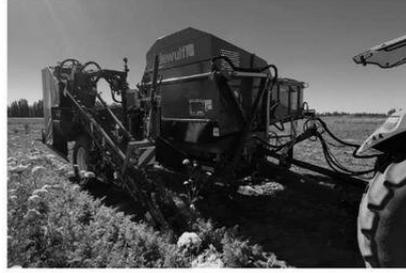
Funciona con un tractor de 80 CV en adelante, reduciendo hasta un 90 % la necesidad de mano de obra. Con ruedas directrices y un cilindro montado en la barra de enganche, garantiza estabilidad y maniobrabilidad incluso en parcelas pequeñas. Actualmente, este nuevo equipo especialista en el cultivo y cosecha de zanahorias, opera en Chile con el servicio de post venta de Dercomaq que ofrece una puesta en marcha con capacitación para asegurar un óptimo desempeño desde el primer uso.
