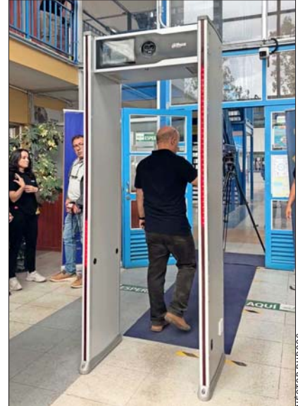
El pórtico también cuenta con una cámara térmica para hacer conteo de personas.
