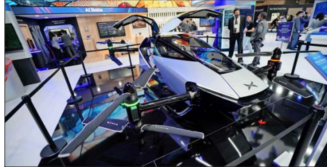
Ocho rotores elevan al Xpeng 2 , un vehículo para dos personas que anda a 130 km/h y tiene una autonomía de 75 kilómetros. Se venderá primero en Australia.
