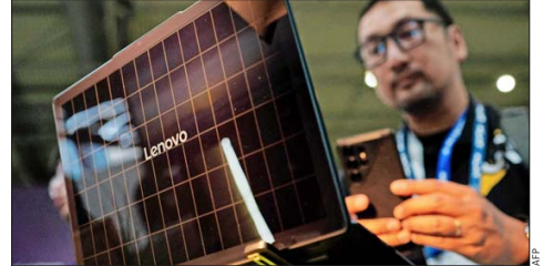
El Lenovo Yoga PC se nutre del sol. Celdas en su parte trasera le dan una hora de energía con solo 20 minutos de exposición solar. Aún es un prototipo.
