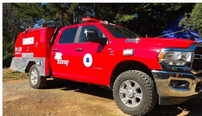
cuenta con un equipamiento de 'Sistema SKID estanque y bomba / Forest Pack', bomba centrífuga con motor independiente, estanque integral de agua y espuma, sistema de entrada y descarga de agua, entre otros instrumentos de operación.
