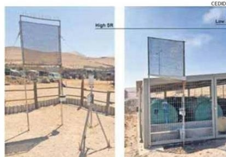
COLECTORES DE NIEBLA ESTÁNDAR CON SR ALTO (IZQ) Y SR BAJO (DER).
