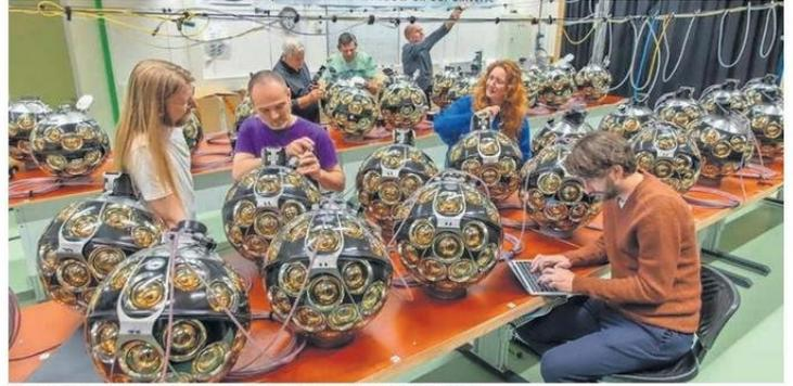
Dos de las unidades de detección del Km<sub>3</sub>NeT, durante el montaje
