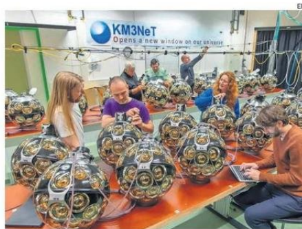
DOS DE LAS UNIDADES DE DETECCIÓN DEL KM3NET, DURANTE EL MONTAJE
