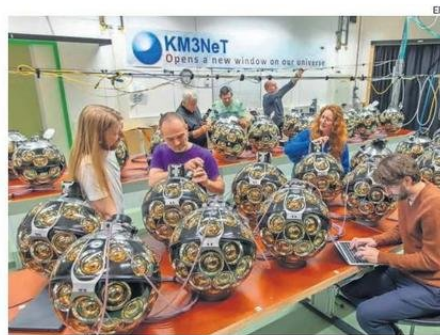
DOS DE LAS UNIDADES DE DETECCIÓN DEL KM3NET, DURANTE EL MONTAJE
