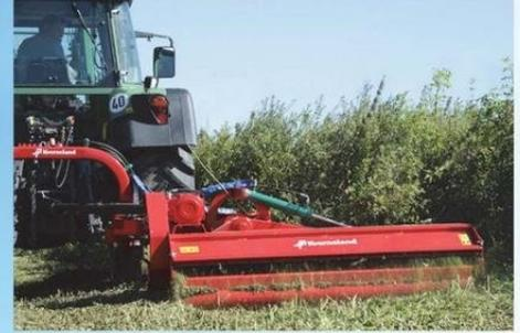
sistema de muelles que equilibra el peso de la barra de corte. Esto permite un trabajo eficiente incluso en suelos irregulares. Además, el sistema breakback evita daños al permitir que la barra se desplace hacia atrás
