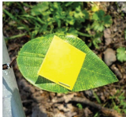
Figura 6: Uso de papeles hidrosensibles para determinar el cubrimiento de pulverizaciones agrícolas. Arriba, papel hidrosensible antes de ser pulverizado. Abajo, papel hidrosensible con óptimo cubrimiento.
