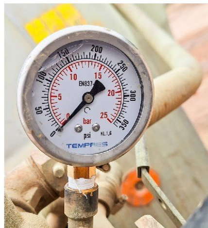
Figura 3: Izquierda, manómetro con escala de 0 a 100 bar, no apropiado. Derecha, manómetro con escala de graduación de 0 a 25 bar, apropiado para uso en pulverizadores hidroneumáticos.
