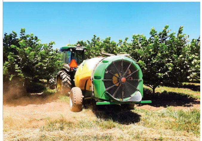
Figura 1: Pulverizador hidroneumático utilizado en cultivos frutales para la aplicación de productos fitosanitarios.
