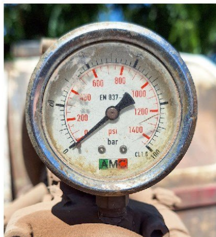
Figura 3: Izquierda, manómetro con escala de 0 a 100 bar, no apropiado. Derecha, manómetro con escala de graduación de 0 a 25 bar, apropiado para uso en pulverizadores hidroneumáticos.
