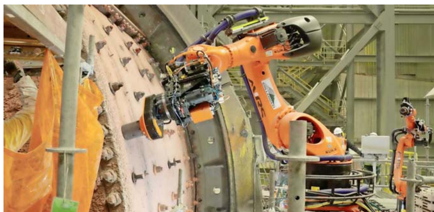
El cambio de revestimientos de molino con un brazo robótico entrega mayor seguridad y productividad.
