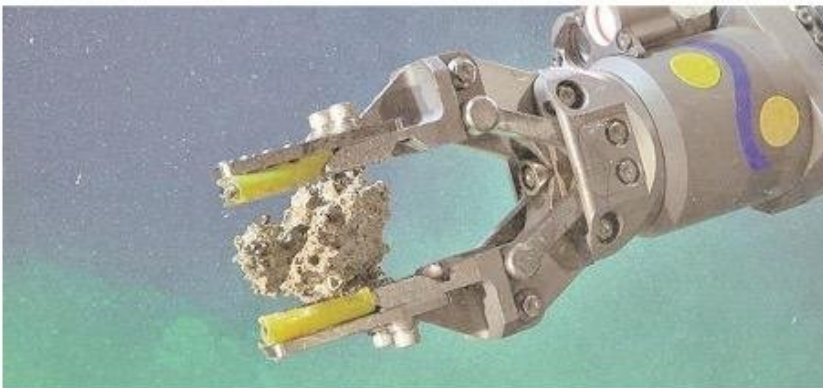
El Rov "SuBastian" recolecta una muestra de roca como parte de las investigaciones.
