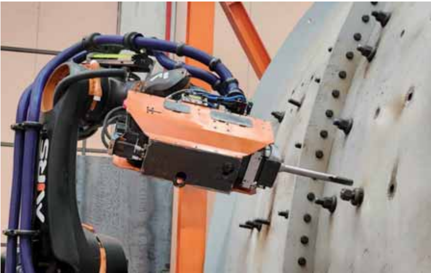
❖ Brazo robótico que cambia el revestimiento del molino SAG en División El Teniente.
