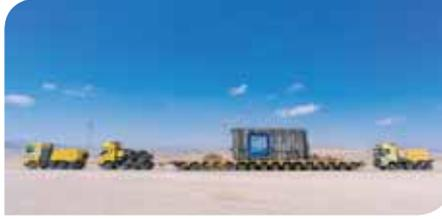
La empresa consolida su presencia como un actor relevante en el rubro energético, proporcionando un Transformador en aceite mineral 280/350MVA, 500/2x33kV, el de mayor potencia suministrado por Weg Chile, y que permitirá
