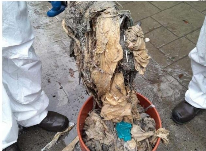
PAPEL HIGIÉNICO, ACEITE DE COCINA, MEDICAMENTOS E INCLUSO PAÑALES SON ARROJADOS AL ALCANTARILLADO.
