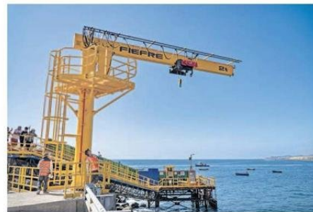
ESTA GRÚA TIENE UNA CAPACIDAD DE CARGA DE 2 TONELADAS.
