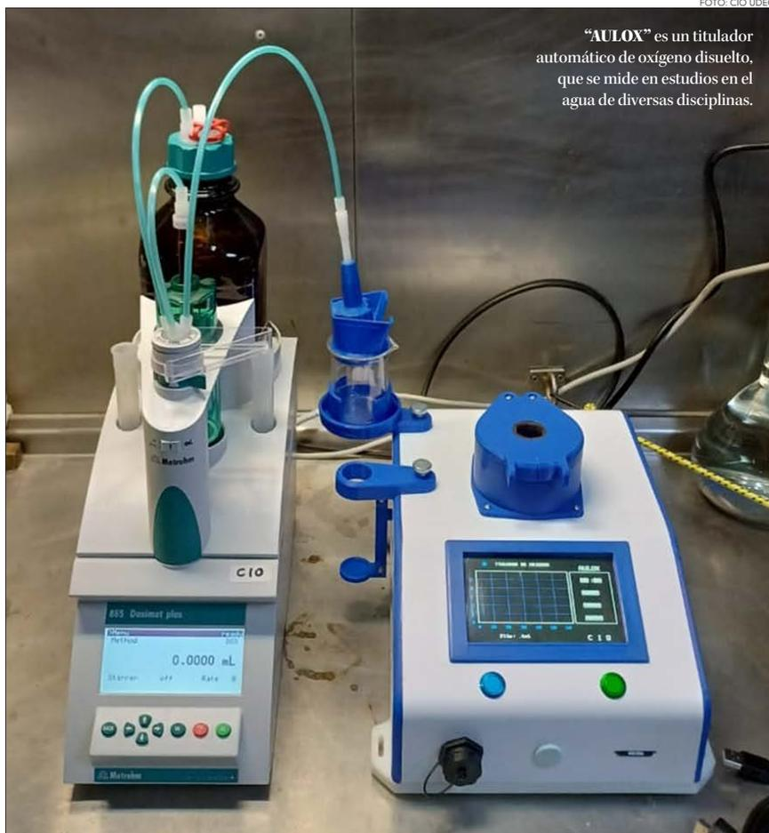
**El equipo permite automatizar el análisis de una variable trascendental para diversas áreas, el oxígeno disuelto en aguas en matrices como río, mar u otras, innovando y mejorando desde el punto de vista técnico al clásico y robusto “método de Winkler” que es el estándar mundial para validar estos análisis.**
