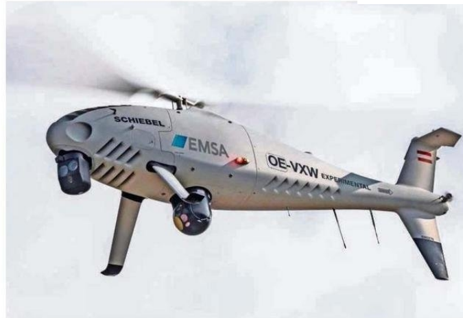
EL UAS CAMCOPTER S-10 CUENTA CON CÁMARAS DE ALTA DEFINICIÓN Y SENSORES PARA AMPLIA VIGILANCIA, AUNQUE SUS RADARES Y CÁMARAS DE ALTA DEFINICIÓN PUEDEN SERVIR PARA RASTREOS Y BÚSQUEDAS.
