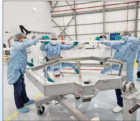
Cada uno de los 798 segmentos que formarán el espejo del telescopio (de casi 40 metros de diámetro) es revestido de cromo, silicio y plata.
