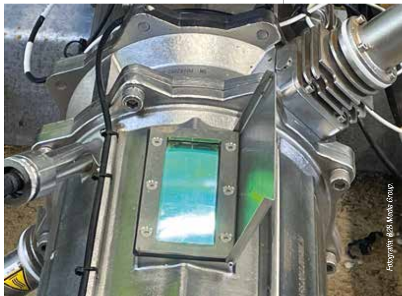
Desinfección de agua con luz ultravioleta.
