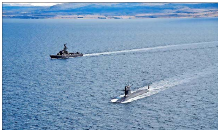
DIMENSIONES. — El submarino tiene 66,4 metros de largo, 8 metros de ancho y un peso de más de 1.700 toneladas. Bajo el agua, se mueve a 21 nudos de velocidad.
