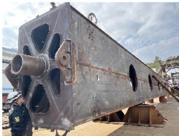
Larguero principal de una ‘vela’ WindWings durante su fabricación.
