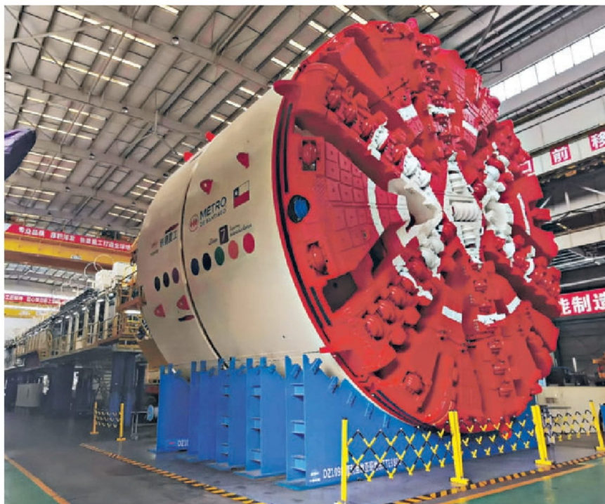
Máquina tuneladora en la Línea 7 del Metro.
