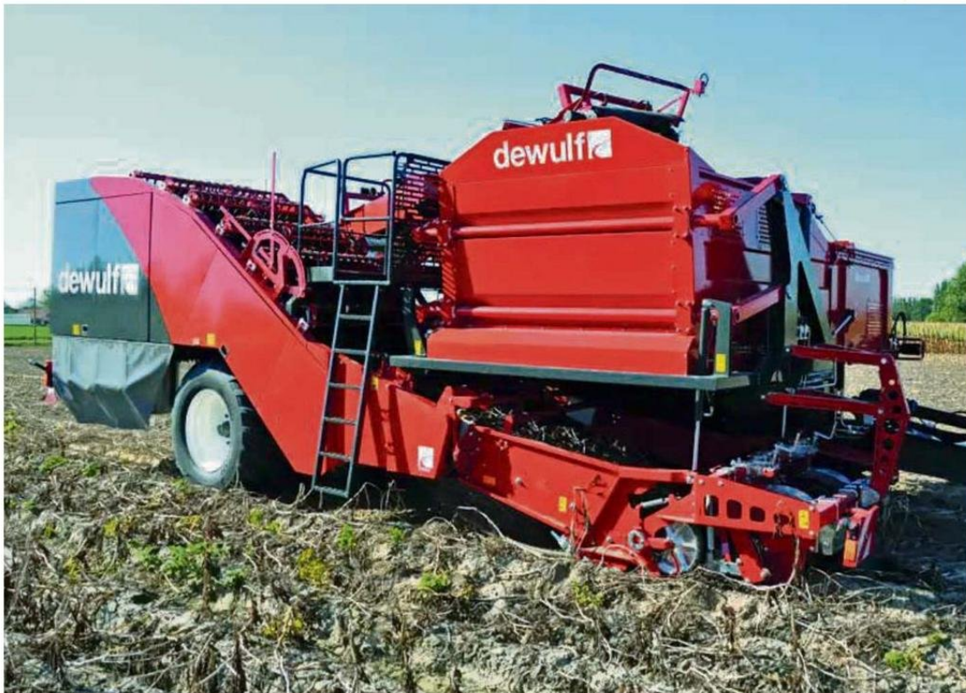
Cosechadora de cribado remolcada Dewulf Torro de 2 hileras es pionera en utilizar la tecnología patentada Inclino Master®, que mantiene la unidad de recolección paralela al campo mientras la cosechadora permanece horizontal. Esto aumenta la rentabilidad y evita daños a las papas durante la recolección.
